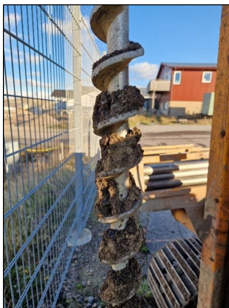
Figur 4.2. Materialet från en skruv, punkt 22NCE.
