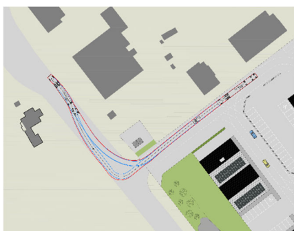
Figur 8. Körspår med specialfordon vid utfart från planområdet i norrgående riktning.
