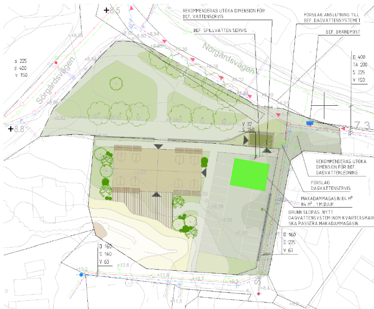
Bild 19 – Karta som visar föreslagen VA- och dagvattenhantering
